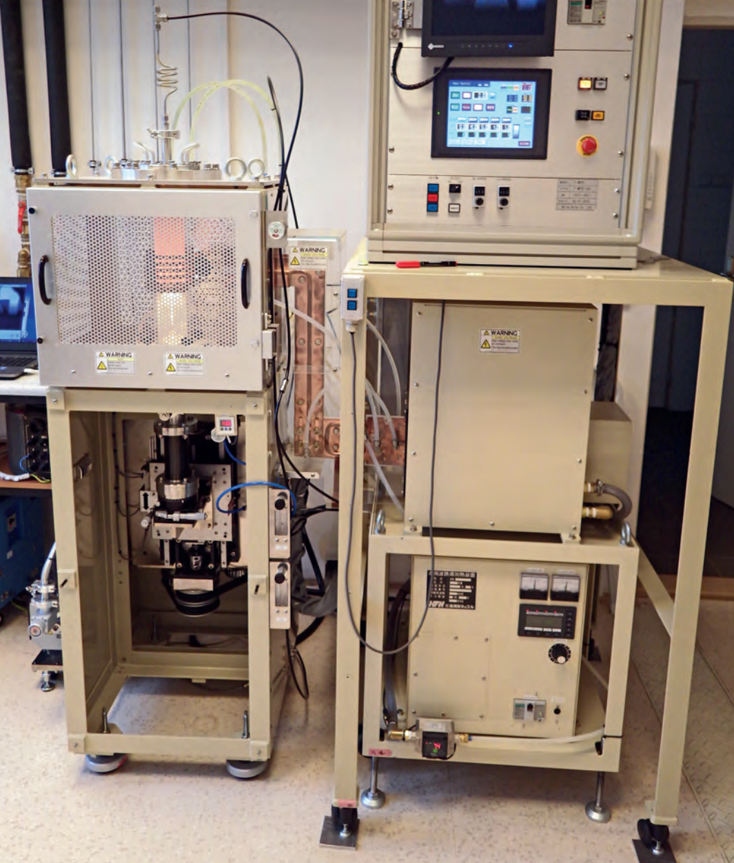
Obr. 4. Aparatura pro pěstování krystalů metodou micro-pulling-down , nainstalovaná ve Fyzikálním ústavu AV ČR
