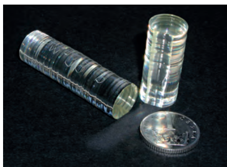
Obr. 7. Scintilační krystal PWO pěstovaný Czochralského metodou na FZÚ AV ČR
