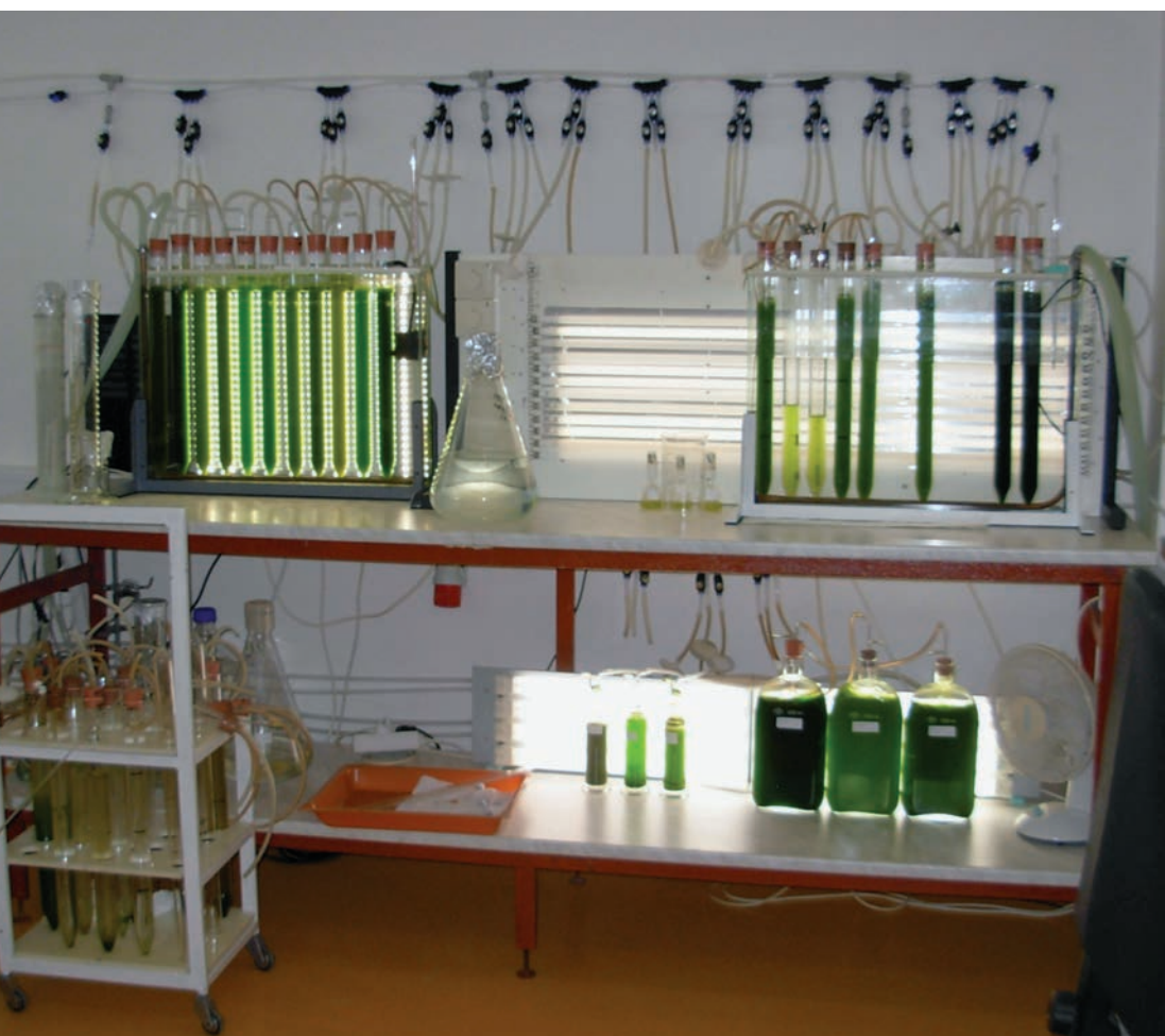
Obr. 3. Laboratorní kultivace mikrořas v různých objemech od 0,5 do 2 litrů Kultivační nádoby jsou osvětleny, temperovány a míchány bubláním směsí vzduchu s 1-2 % \text{CO}_2
