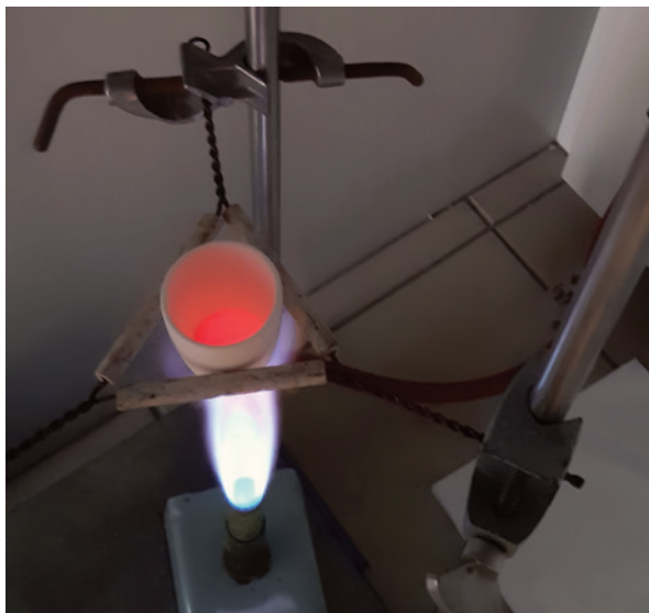
Obr. 16 Tavení odolného vzorku s peroxidem sodným – stanovení obsahu platinových kovů v katalyzátoru automobilu
