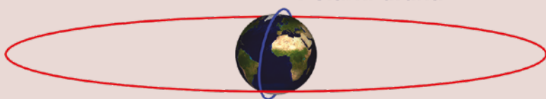
Obr. 1 Znáznornění polární (modrá barva) a geostacionární (červená barva) oběžné dráhy meteorologických družic
