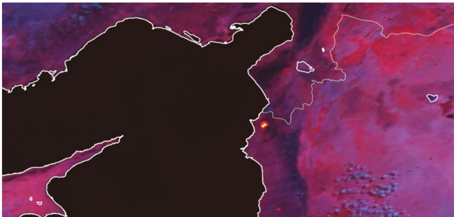
Obr. 12 Příklad kompozitního snímku Fire Temperature RGB složeného z IR3.8 \mu\text{m} , NIR2.25 \mu\text{m} a NIR1.6 \mu\text{m} ze 4. 7. 2025, 10:40 UTC [Zdroj dat: © EUMETSAT 2025]
