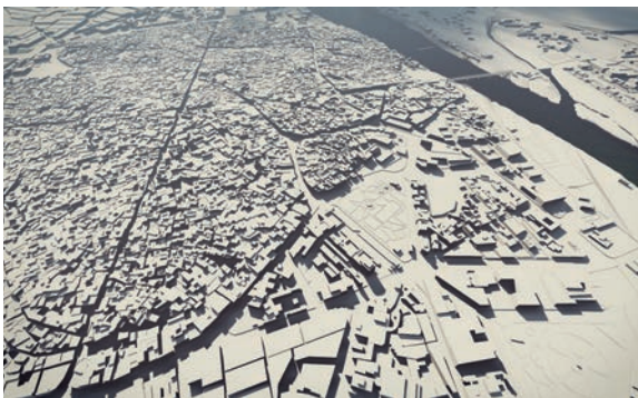
Jako základ interaktivní mapy Mosulu byl vybrán satelitní snímek s vysokým rozlišením ze systému WorldView-2. Snímek byl vektorizován do podoby podrobné topografické mapy, která se stala základem pro 3D model historického centra Mosulu (archiv Orientálního ústavu AV ČR)
