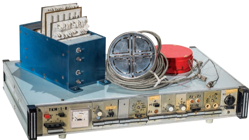
Obr. 2 Přístroj KM 1R včetně senzoru pro měření vlastností chladného plazmatu na družici Interkosmos 8, spolu se svou pozemní kontrolní aparaturou (foto M. Frouz)
