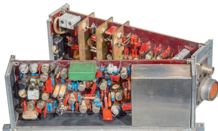
Obr. 1 První přístroj určený pro práci na palubě družice, který byl v ionosférickém oddělení Geofyzikálního ústavu ČSAV vyvinut, byl telemetrický vysílač pro družici Interkosmos 3 z roku 1970 (foto M. Frouz)
